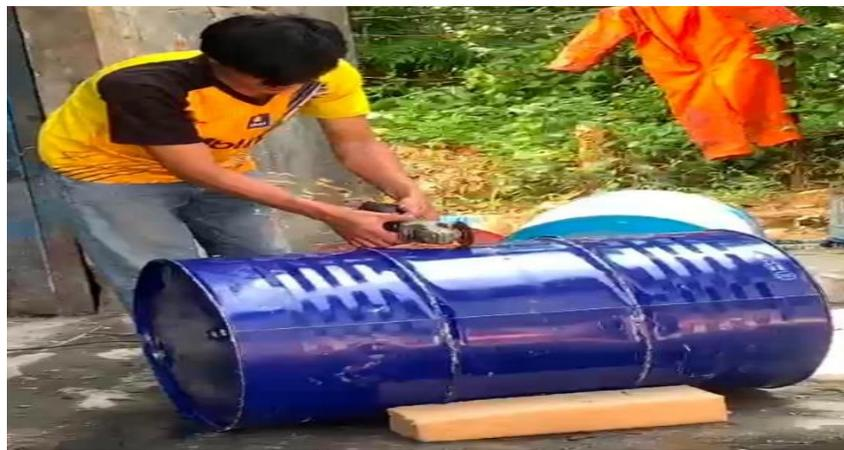
Gambar 1. Proses Pemotongan Drum Besi Menjadi Dua Bagian
